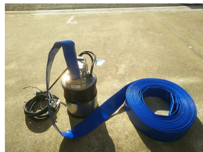
《排水ポンプとホースを繋いで準備完了》
